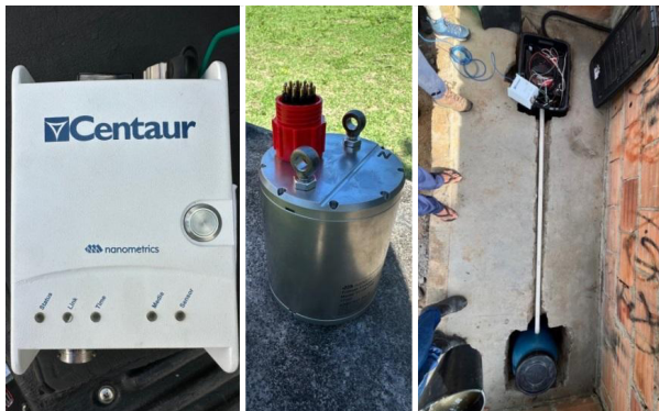
FIGURA 1. REGISTRADOR, E SENSOR (AS DUAS PARTES PRINCIPAIS DO SISMÓGRAFO) E ESTAÇÃO SISMOGRÁFICA EM ITAÚNAS (ES) PARA MONITORAMENTO SISMOLÓGICO
