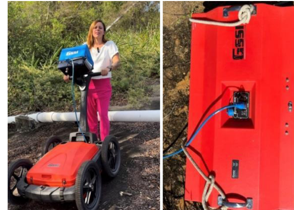
FIGURA 2. GROUND PENETRATING RADAR (GPR). ANTENA DE 250MHZ E 100MHZ). UTILIZADO PARA INVESTIGAÇÃO DE ESTRUTURAS SUBSUPERFICIAIS
